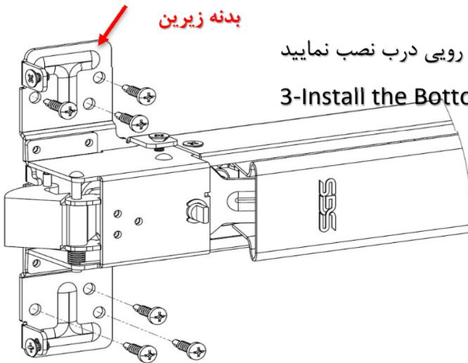
۴- با استفاده از ۲ عدد پیچ سر مته ، قطعه فلزی L شکل انتهایی را نصب نمایید
